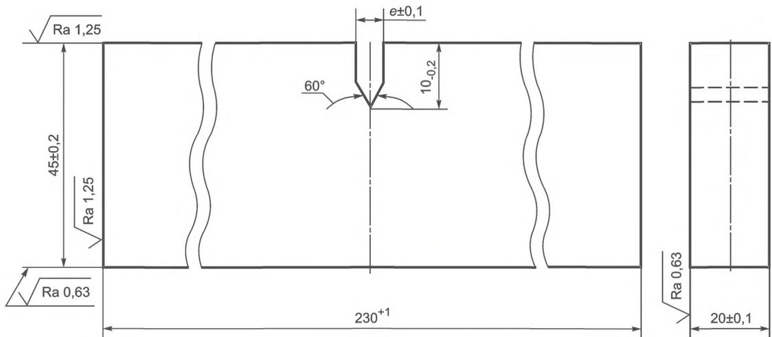
Радиус закругления дна надреза должен быть не более 0,25 мм, шероховатость поверхностей надреза не более Ra 1,25.
