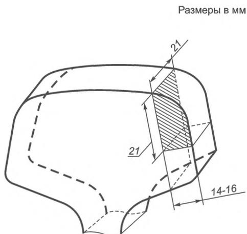
Рисунок 4 — Схема расположения шлифа для контроля неметаллических включений
