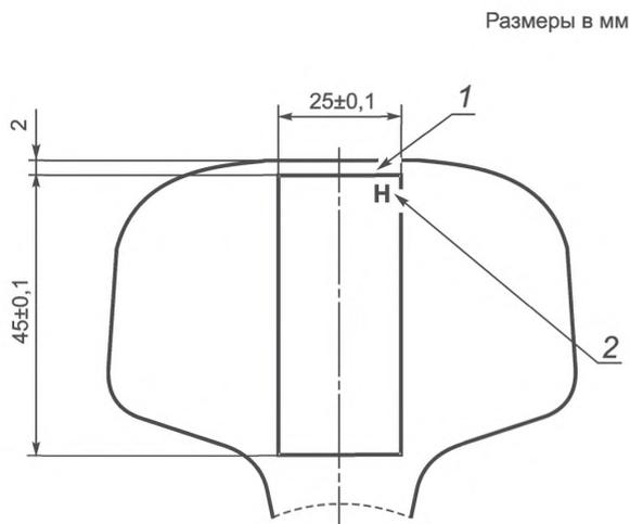
Надрез наносят со стороны верха образца (стрелка 1),
