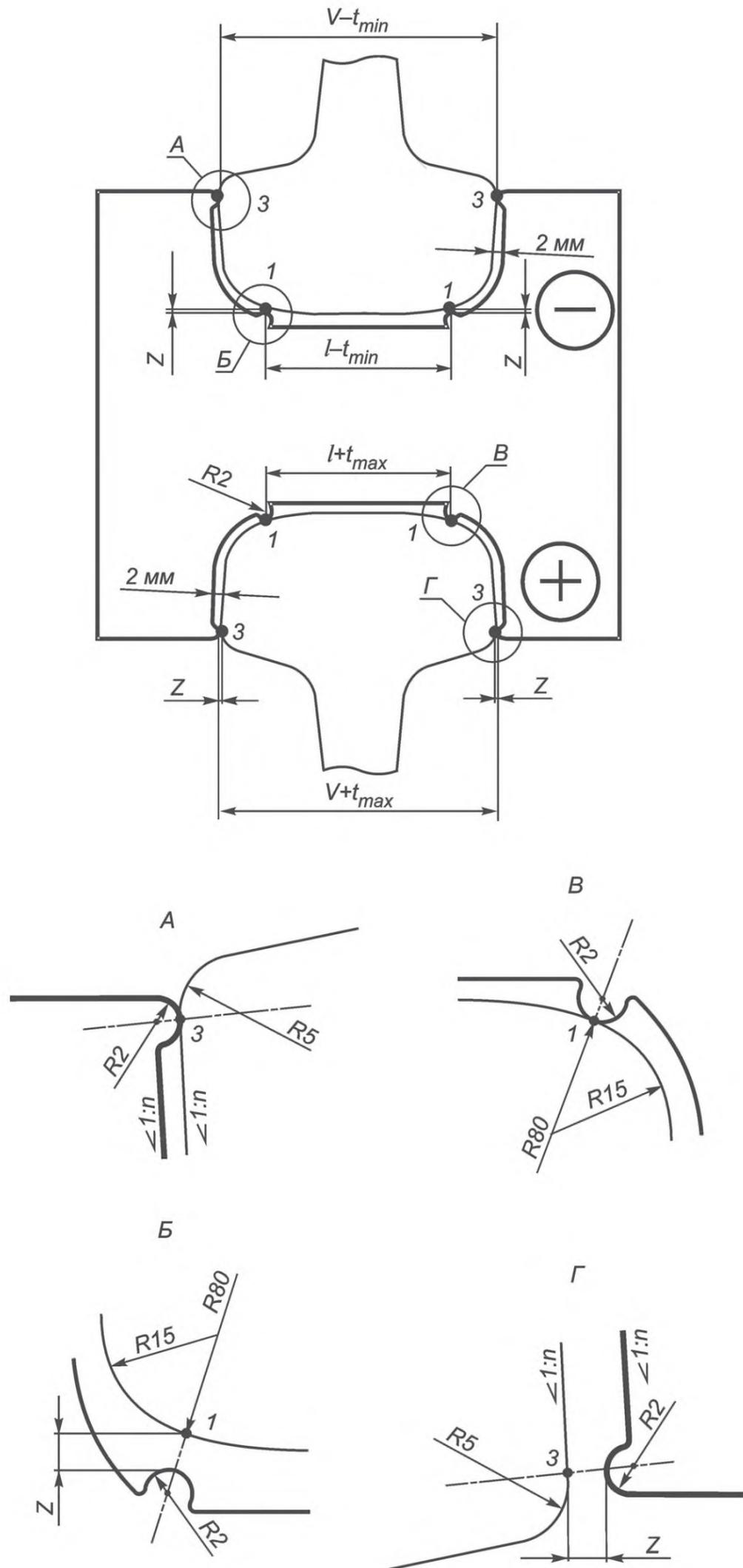
$t_{max}$ ,  $t_{min}$  — максимальный и минимальный допуски ширины головки рельса;
