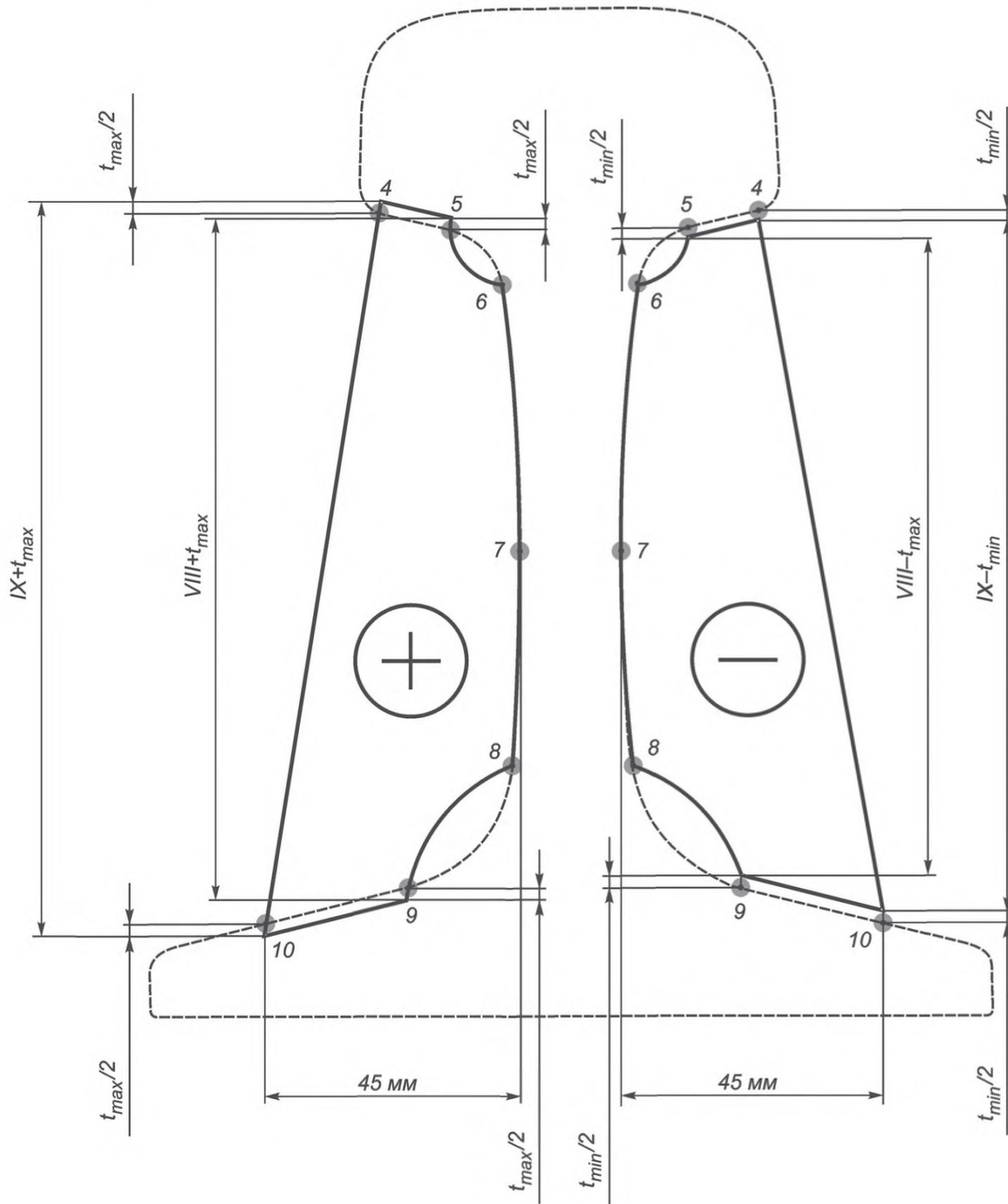
$t_{max}$ ,  $t_{min}$  — максимальный и минимальный допуски высоты шейки;
