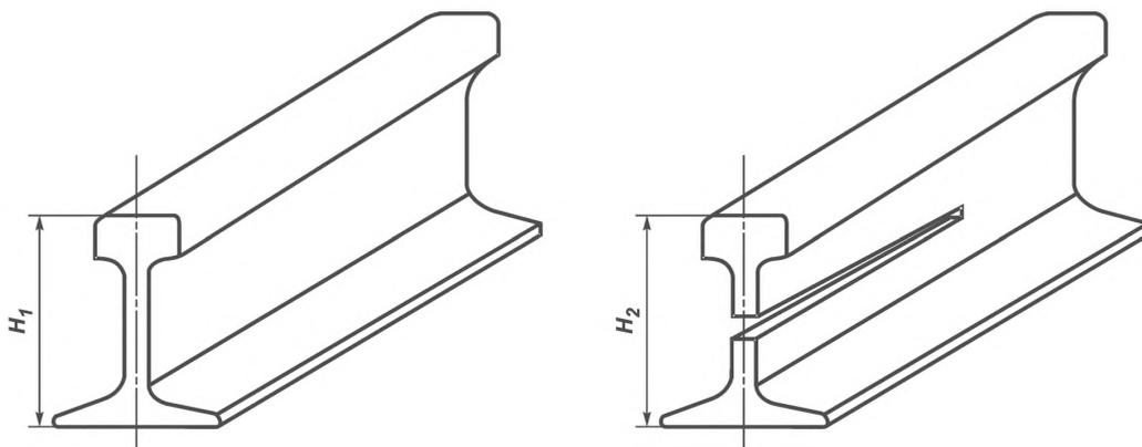
Рисунок 5 — Схема определения остаточных напряжений в шейке рельсов
