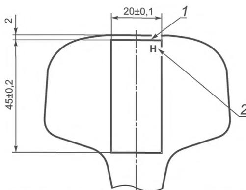
Надрез наносят со стороны верха образца (стрелка 1),
