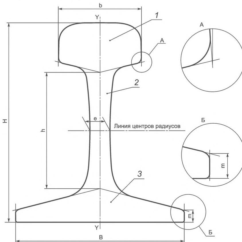
1 — головка рельса; 2 — шейка рельса; 3 — подошва рельса
