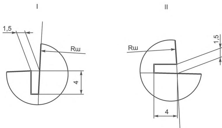
Рисунок Ж.14 — Шаблон контроля фасок болтовых отверстий
